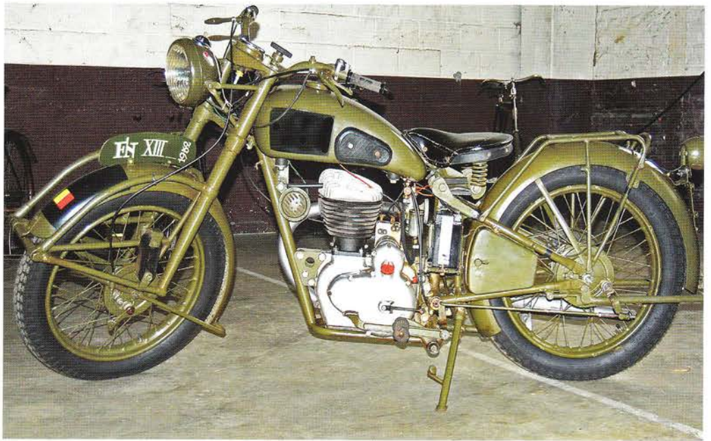
FN XIII de l'armée belge monocylindre de 350 cc (1952).
